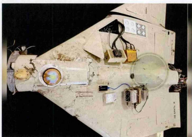
GERAN-2 abbattuto equipaggiato con telecamera, antenna CRPA, e modulo AI Nvidia Jetson.
