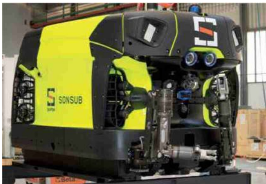
La nave gru semisommersibile Saipem 7000. Sotto, Hydrone, un drone sottomarino per interventi sui fondali
