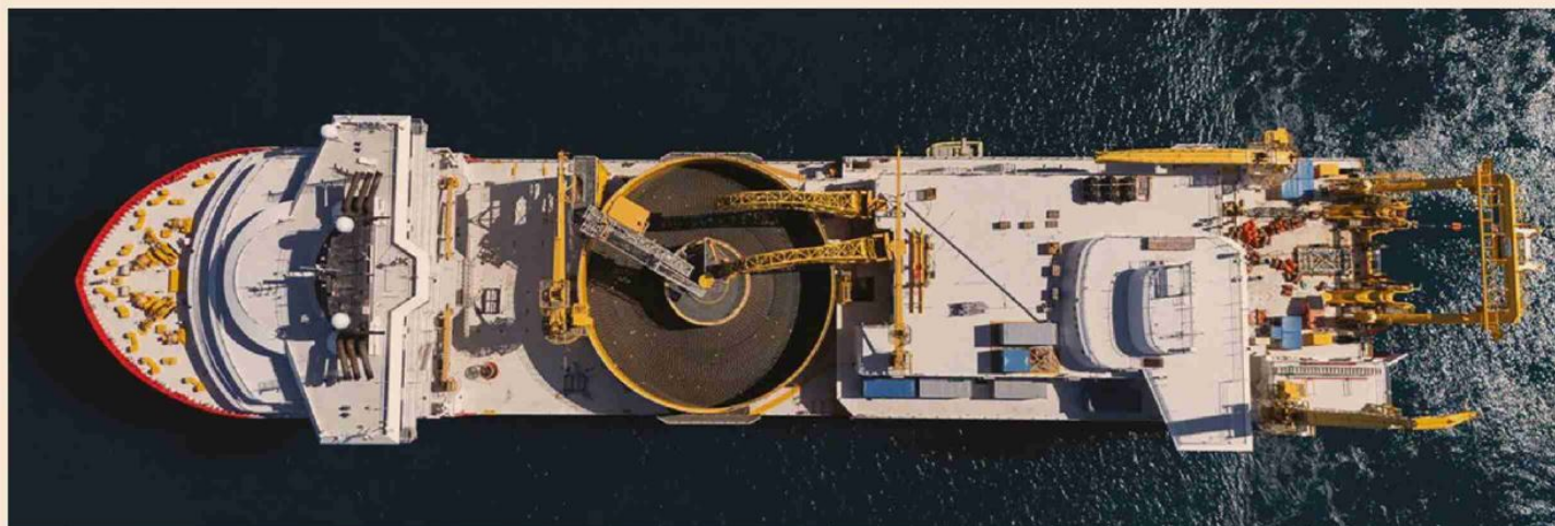
Collegamenti. La nave Aurora di Nexans utilizzata per le attività di posa del primo cavo sottomarino del ramo ovest del Tyrrhenian Link di Terna
